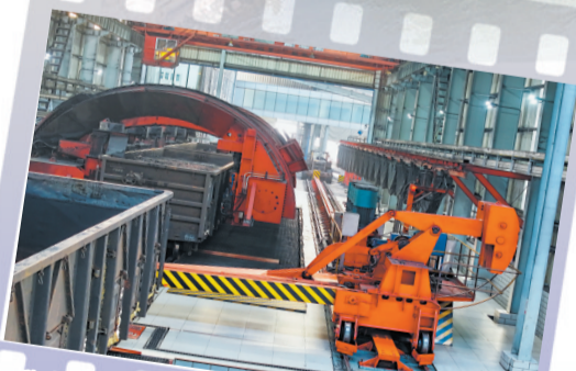
聊城市信发集团全自动输煤储煤自动装卸系统,年减少二氧化碳、氮氧化物等汽车尾气排放近2000吨
