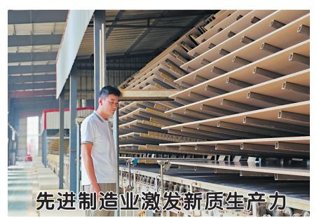
日前,在曹县庄寨镇茂盛木业30万立方米连续平压生产线上,经过施胶、铺装、 压机、锁边、晾晒、包装等工序,高标准板材被批量生产出来。
